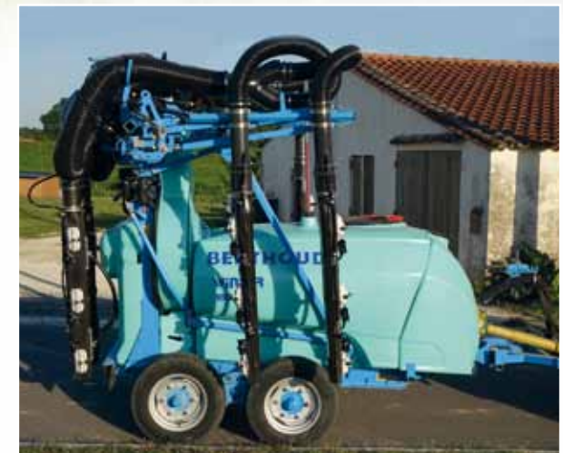
Repliage des bras en position horizontale Permet de limiter l'encombrement en hauteur.
