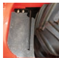
Décrottoirs de roues pneus
